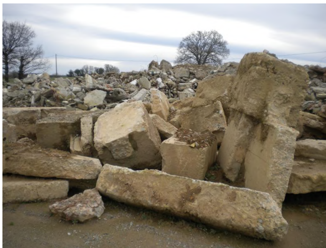
Type de blocs de béton armé susceptible d'être recyclés sur le site
