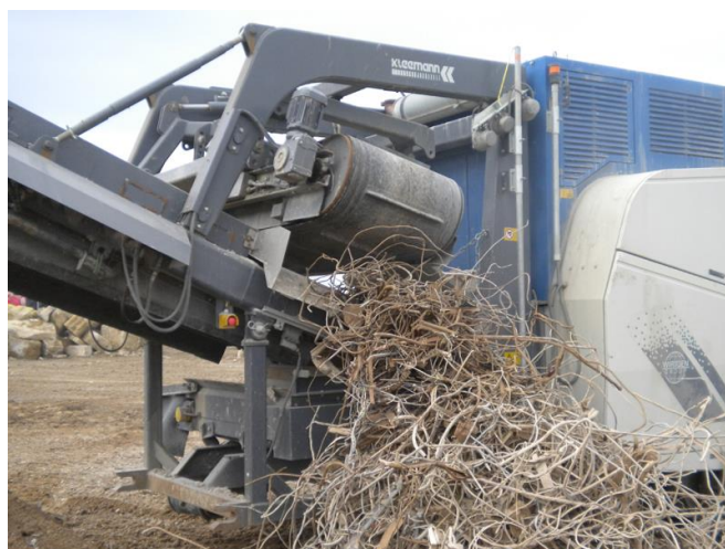
Exemple de tri permis par le séparateur magnétique (anciennes armatures de béton)
